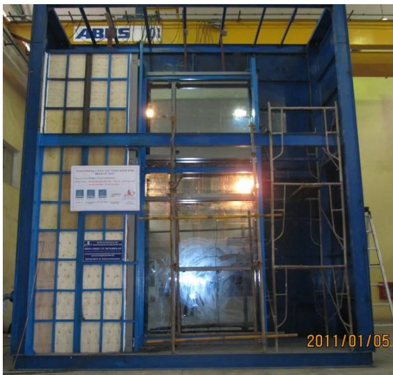
a) Thí nghiệm mặt dựng nhôm kính của công trình tòa nhà PV GAS (Hồ Chí Minh) [1]
