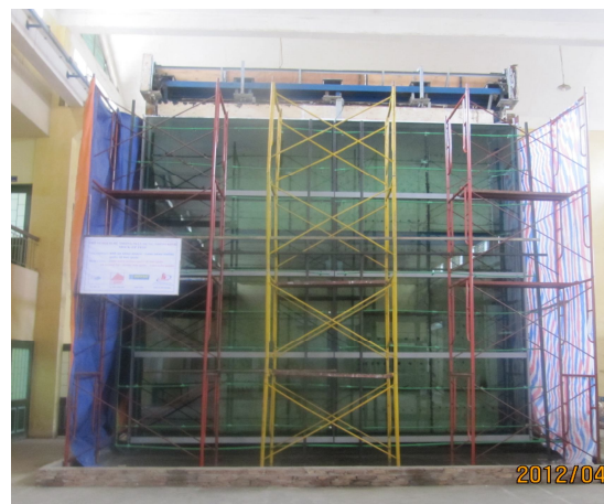
d) Thí nghiệm mặt dựng nhôm kính của công trình Nhà ga Hành khách sân bay Phú Quốc (Kiên Giang) [4]
