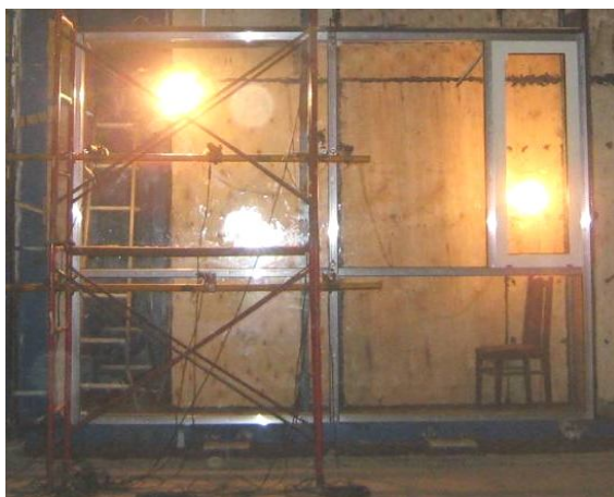
c) Thí nghiệm mặt dựng nhôm kính của công trình tòa nhà trụ sở hải quan (Hà Nội) [3]
